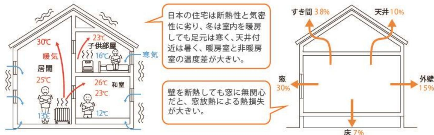
※ハイブリッドフォームなら気密性、断熱性に優れているため、従来の断熱工法より部屋間の温度差を減らすことができます。
